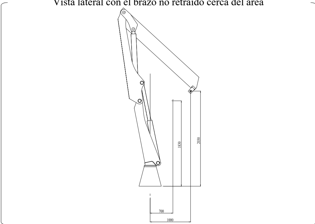
Vista lateral con el brazo no retraído cerca del área
