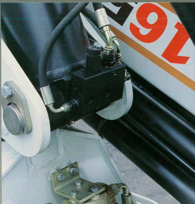
**Valvole flangiate direttamente sui cilindri.**
